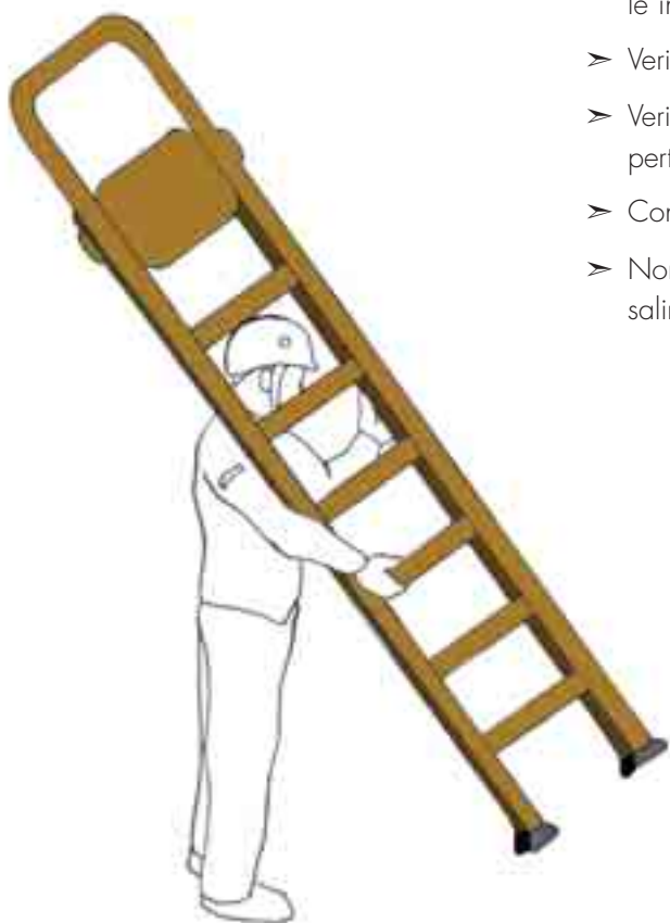
Fig. 8 - Modalità corretta di trasporto della scala a spalla
