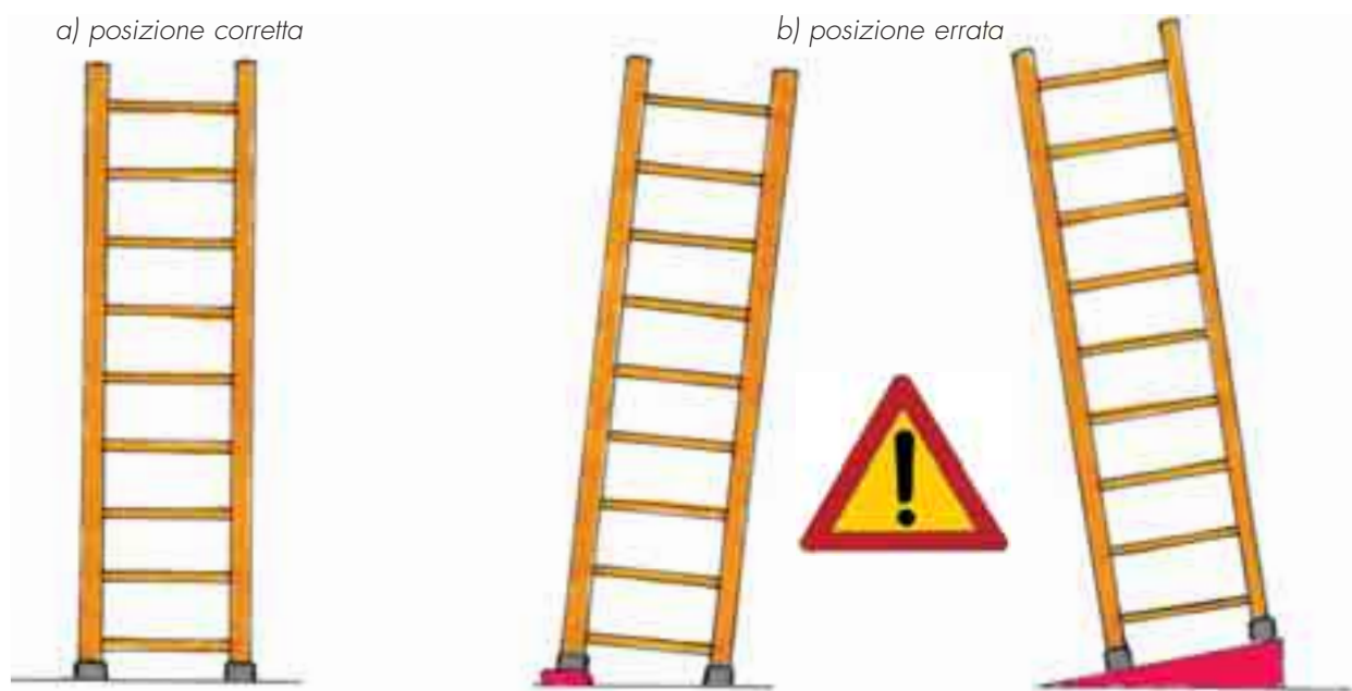
Fig. 25 - Superficie inclinata lateralmente. Appoggiare la scala solo su superficie orizzontale
