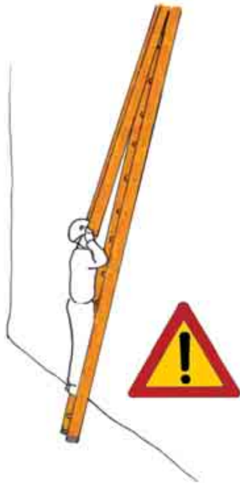
Fig. 39 - Modalità errata di montaggio
